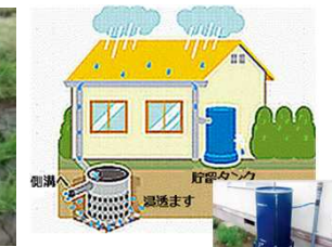
雨水浸透ます・貯留タンク設置 （信濃川水系：新潟市他）
