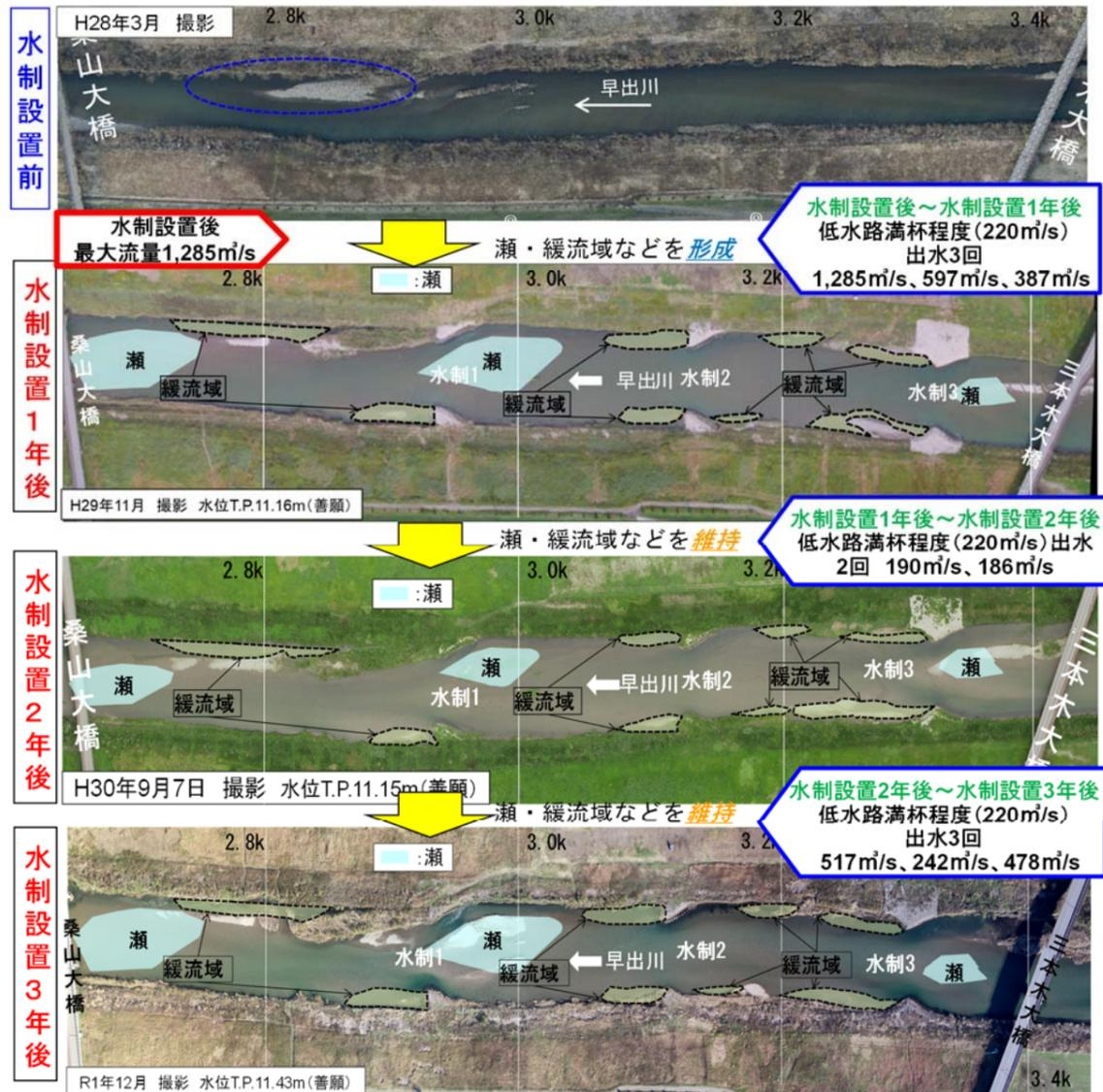
図 4.5-2 水制の設置による多様な流れの再生状況
