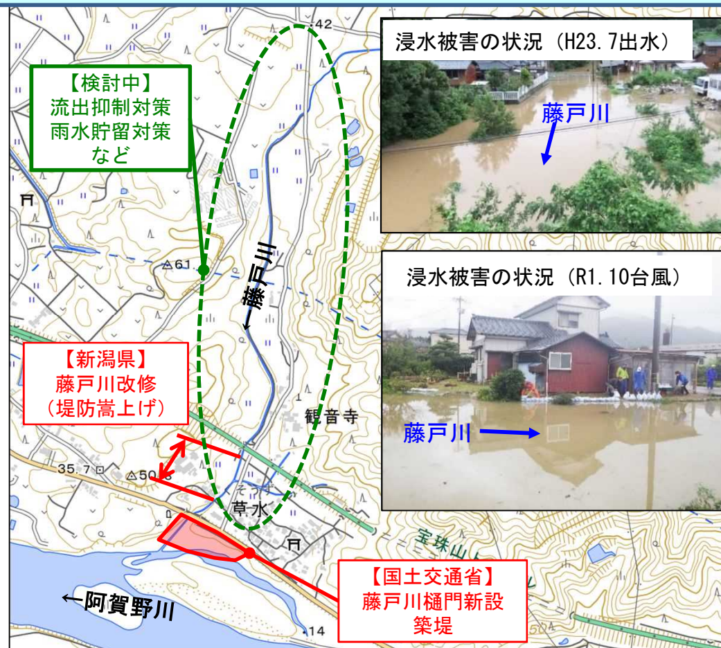
藤戸川排水樋門・築堤・護岸イメージ図 藤戸川樋門・築堤整備イメージ図
