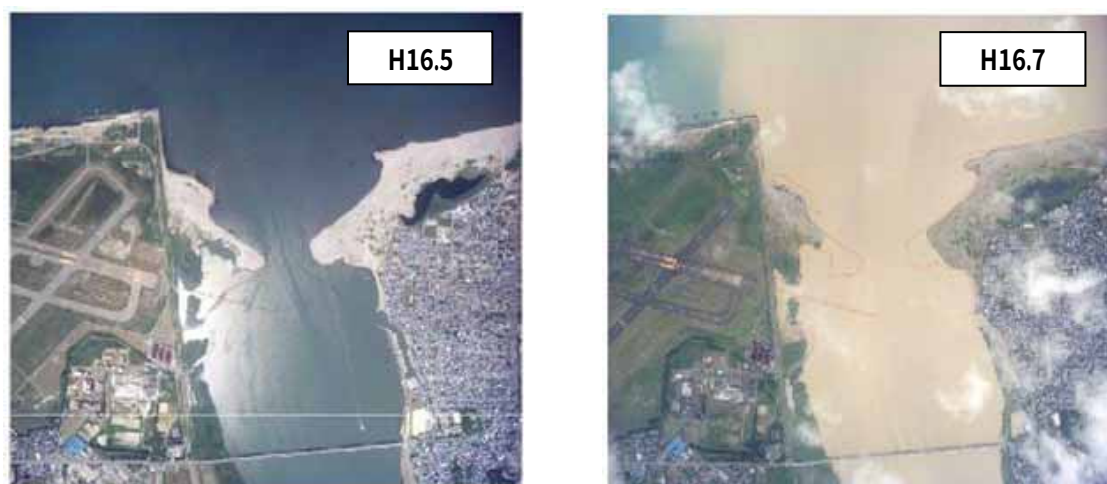
図 II-41 洪水による河口砂州の変化
