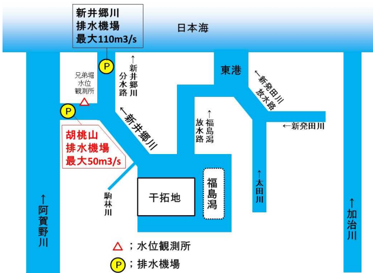
阿賀北地域の河川と排水機場
