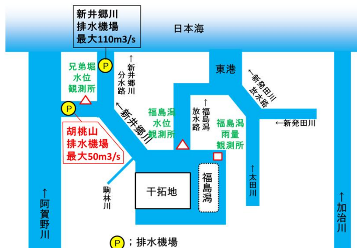
阿賀北地域の河川と排水機場
