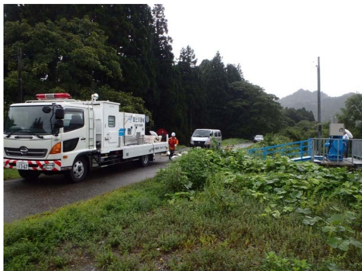
排水ポンプ車による排水作業：9月10日12時～18時
