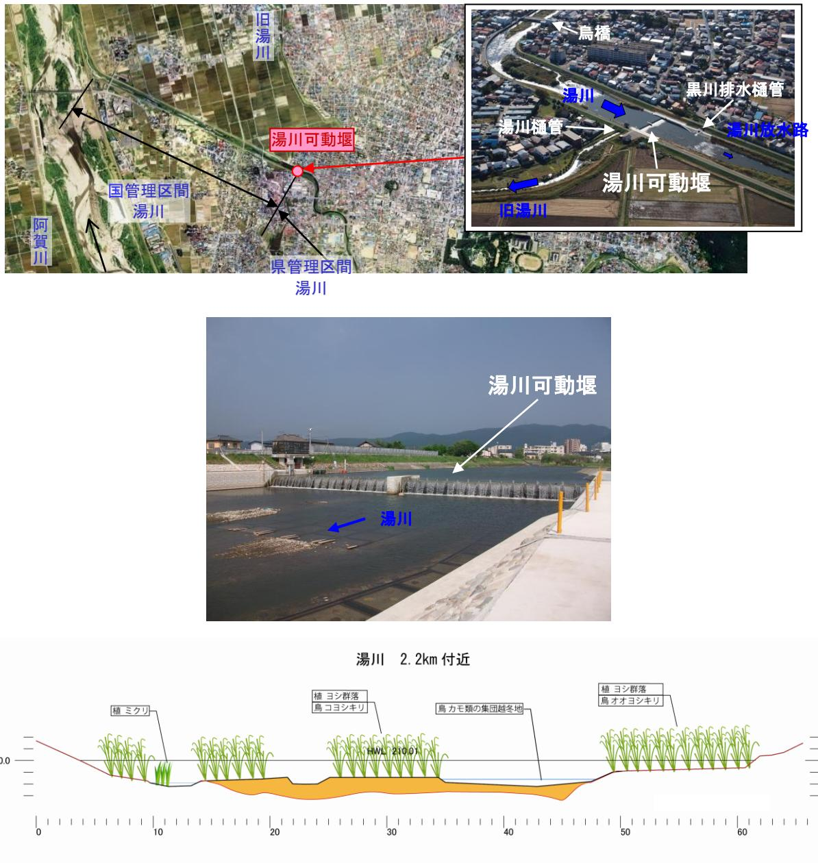
図 5.12 湯川可動堰と堰上流の河道掘削のイメージ
