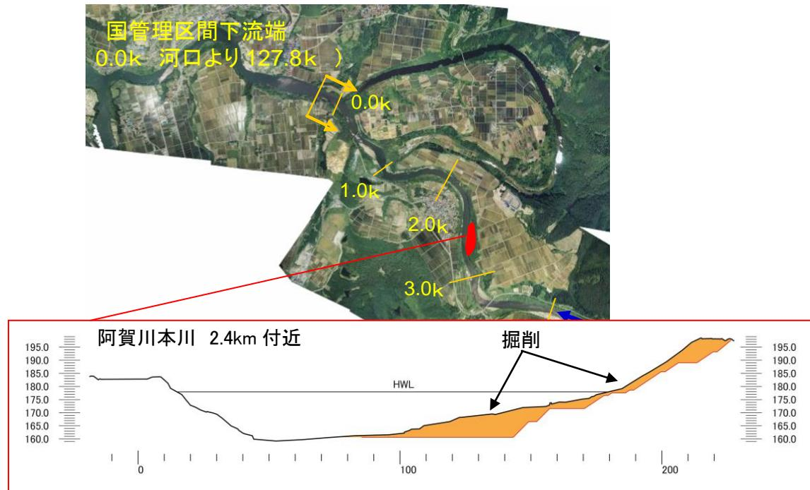
図 5.3 主な改修箇所のイメージ図 (2.4k 附近)
