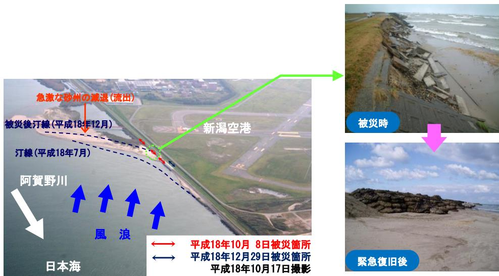
写真 3.52 波浪による河口部護岸の被災（平成 18 年 10 月, 12 月）
