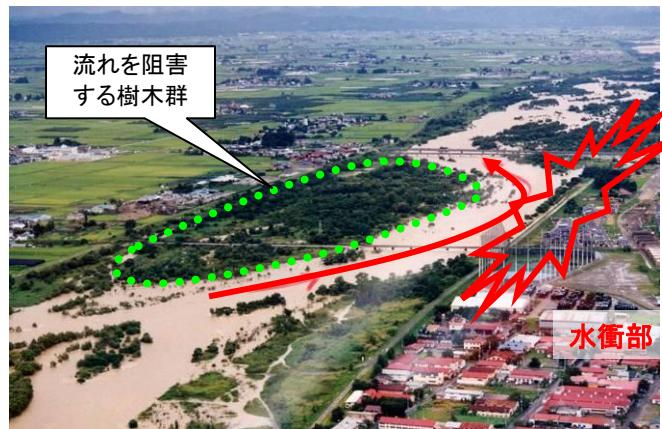
写真 3.37 洪水時の偏流発生状況
