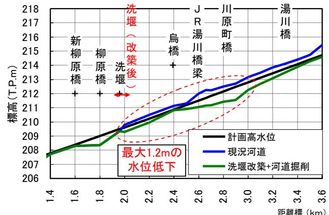
図 5.11 水位縦断図（計画高水量流下時）
