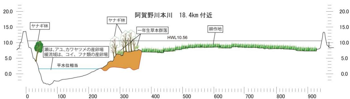
図 5.8 主要な改修箇所のイメージ（中新田地区 右岸 18.4k）
