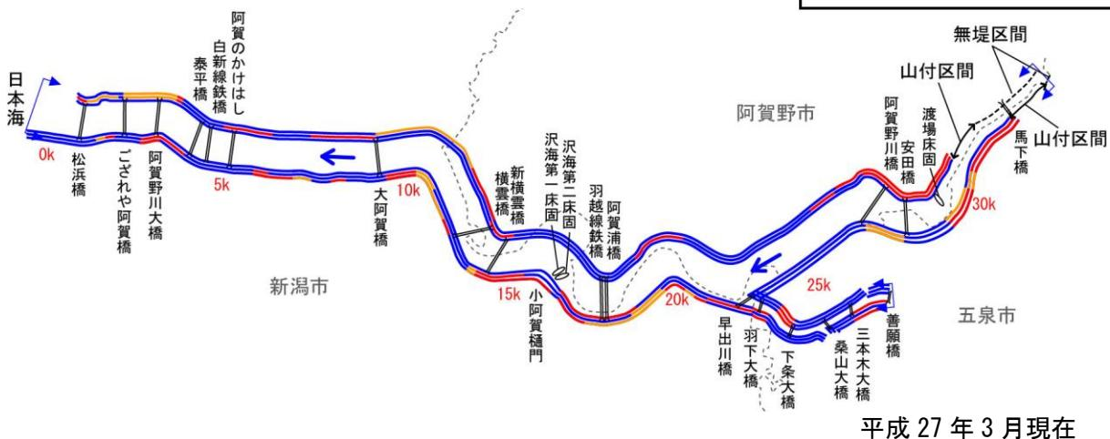
図 5.10 堤防の浸透対策区間（堤防の詳細点検結果より）
