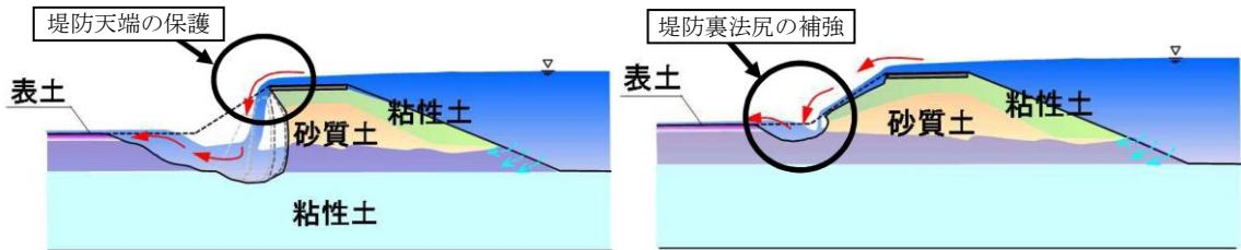
図 5.32 粘り強い構造の堤防
