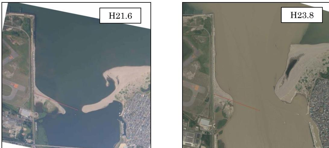
写真 5.20 洪水による河口砂州の変化
