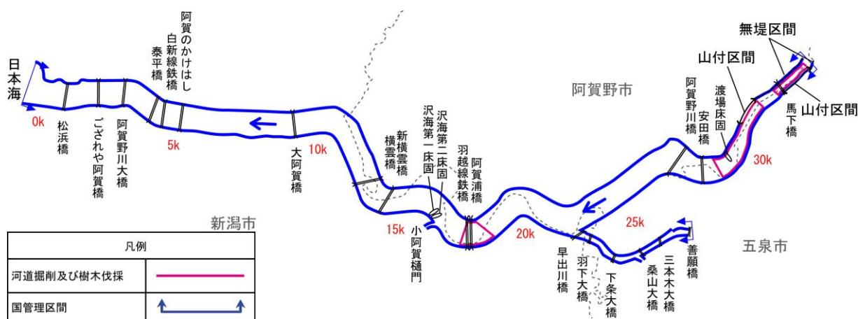
図 5.7 河道掘削・樹木伐採区間
