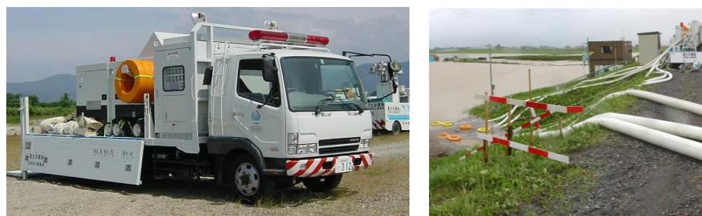
写真 3.56 排水ポンプ車及び稼動状況
