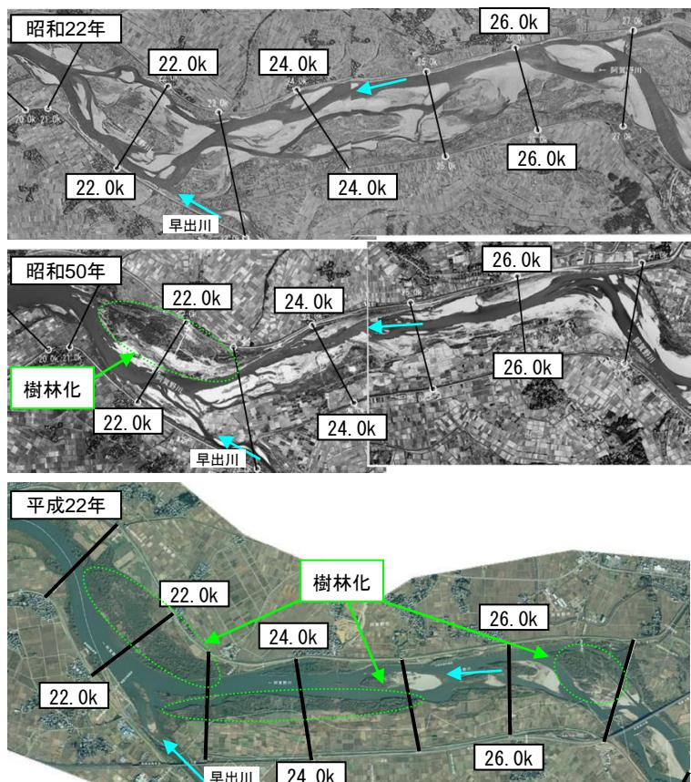
写真 3.47 阿賀野川の河道の変遷 (21.0k~27.0k)
