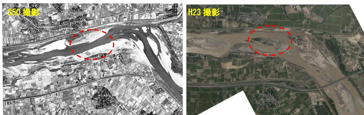
図 3.28 陸部と水部の二極化の例【26.0k付近】
