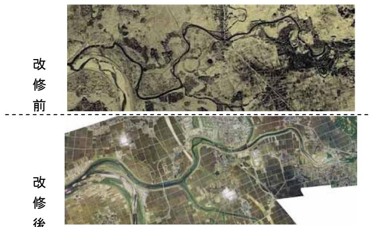
写真 3.13 日橋川改修による流路の変更
