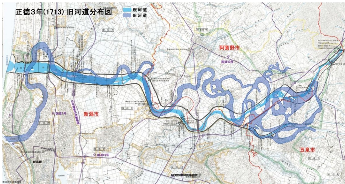
図 3.19 旧河道上に築造された現在の堤防
