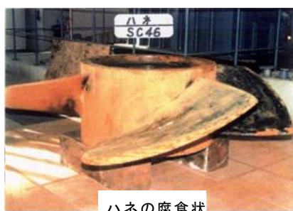
写真 3.51 胡桃山排水機場設備の塩害による劣化
