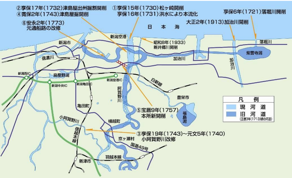
図 3.6 藩政期の阿賀野川改修
