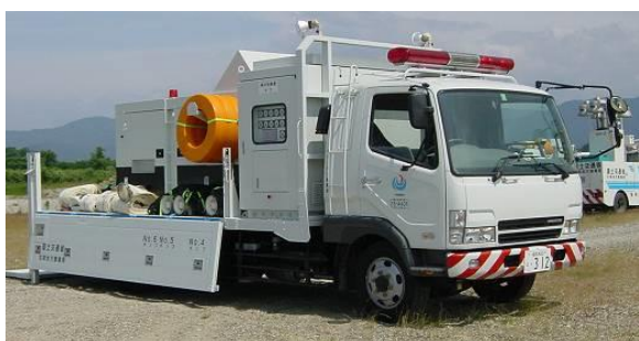
写真 3.56 排水ポンプ車及び稼動状況
