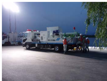
図 II-56 排水ポンプ車
