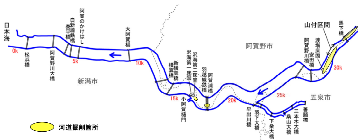
図 II-9 河道の掘削区間
