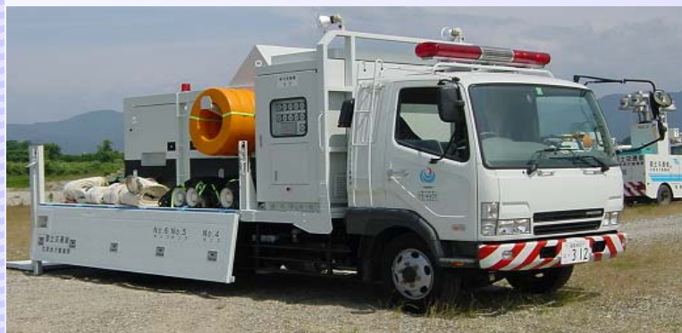
排水ポンプ車
