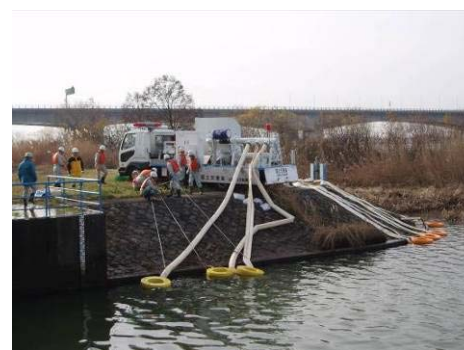
排水ポンプ車操作訓練
