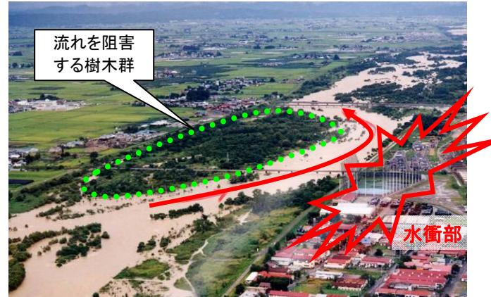
図 3.57 洪水時の偏流発生状況
