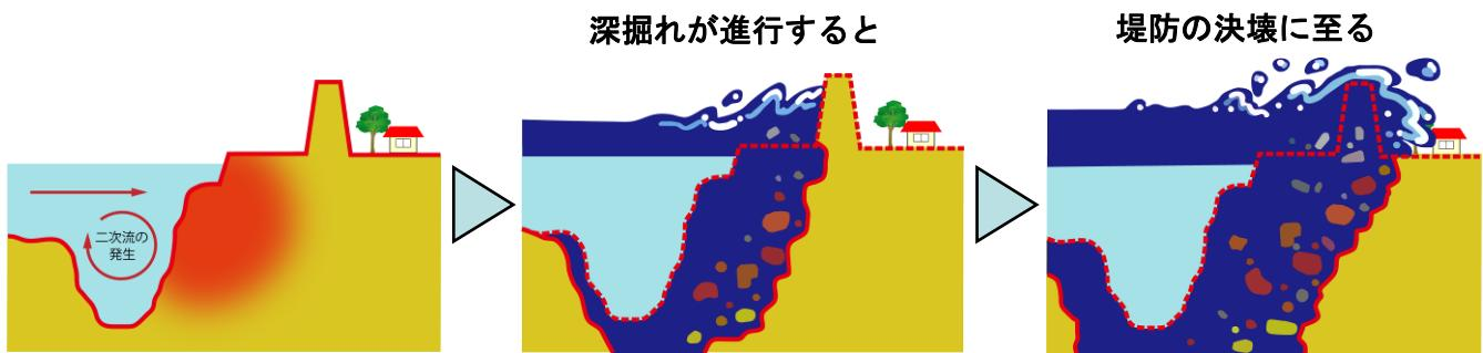
図 3.60 破堤のメカニズム
