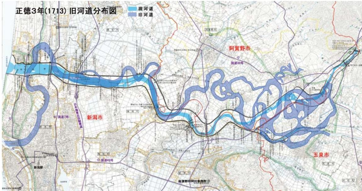
図 3.52 旧河道上に築造された現在の堤防
