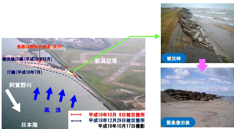
図 3.84 波浪による河口部護岸の被災（平成 18 年 10 月, 12 月）
