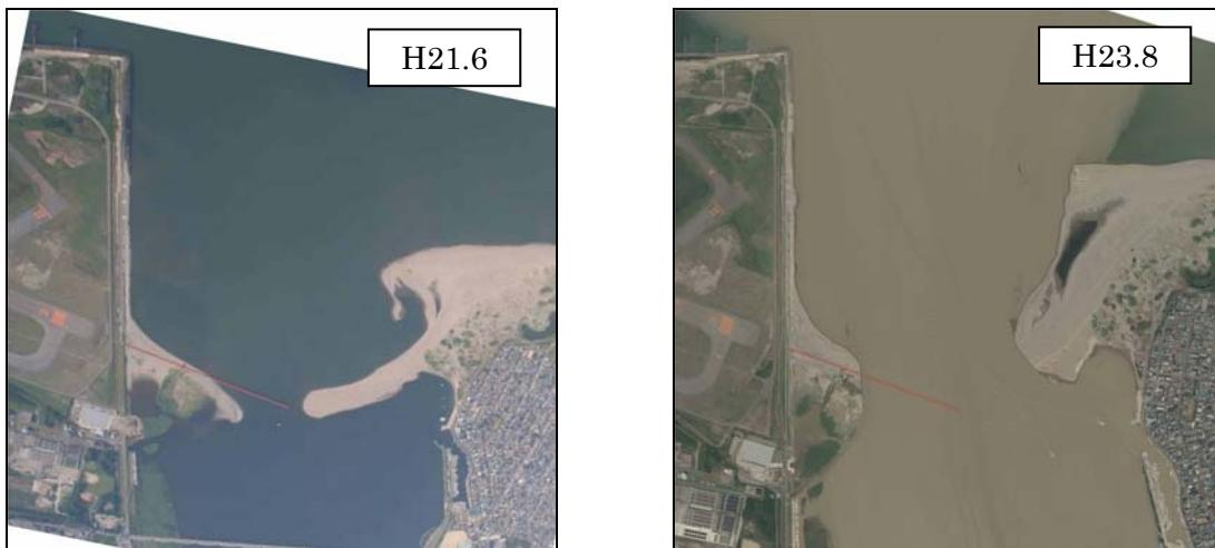
図 5.44 洪水による河口砂州の変化
