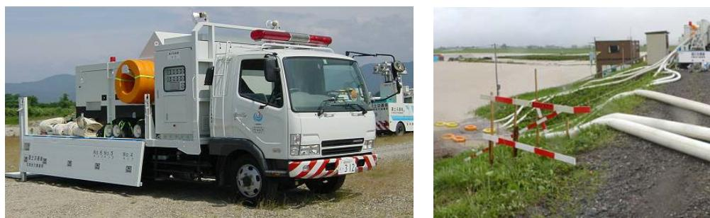
図 3.92 排水ポンプ車及び稼動状況
