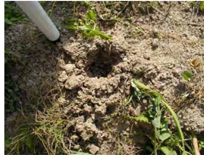
基盤漏水により発生したガマ跡
