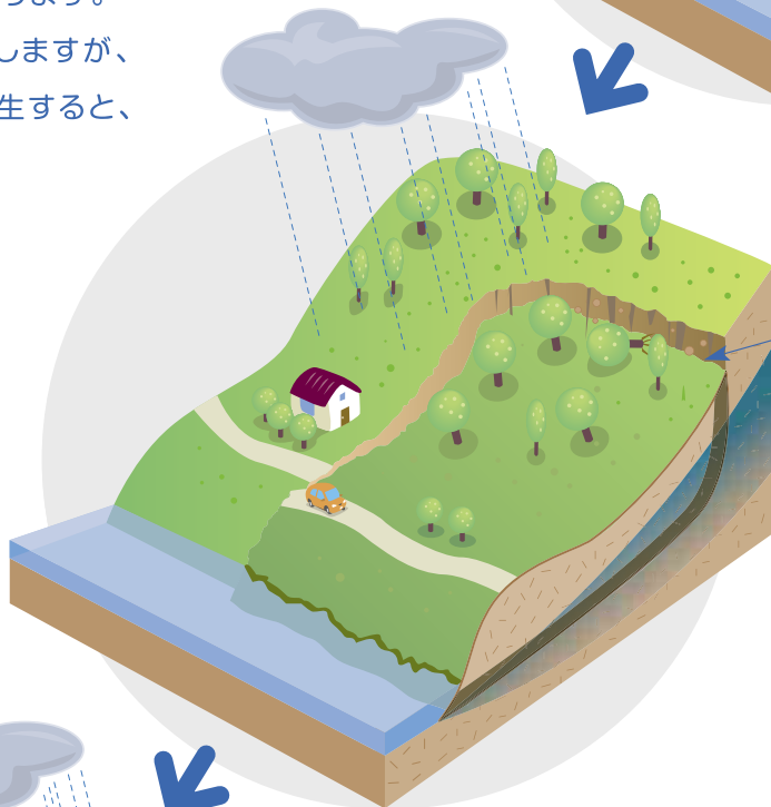
●亀裂や陥没の発生
