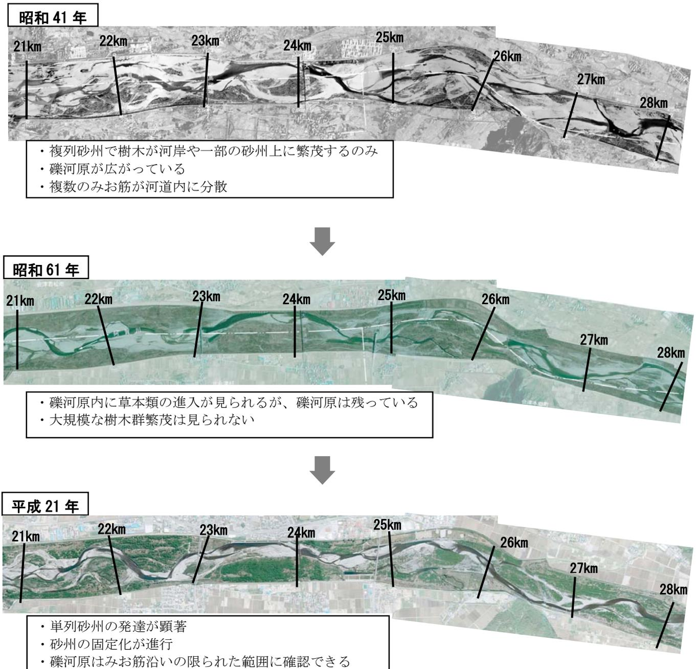
図 3.1 航空写真で見る河道の変遷 (21k~28k)
