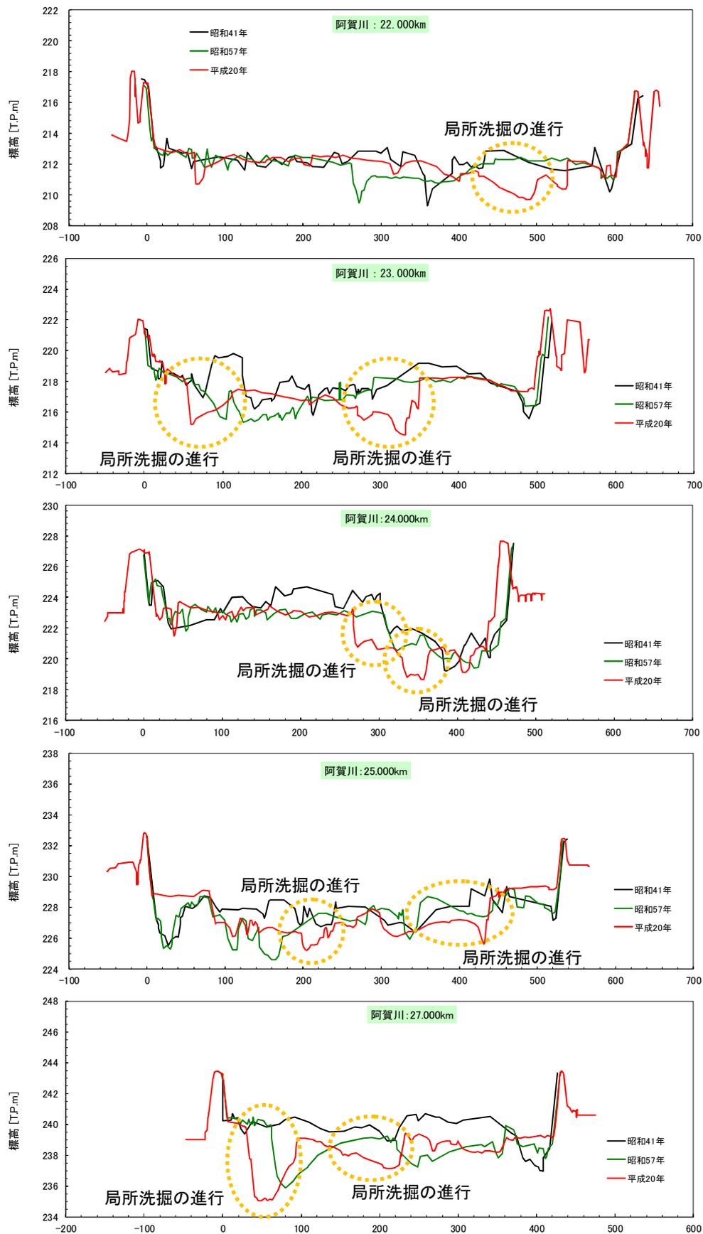
図 3.3 河道横断形状の変化
