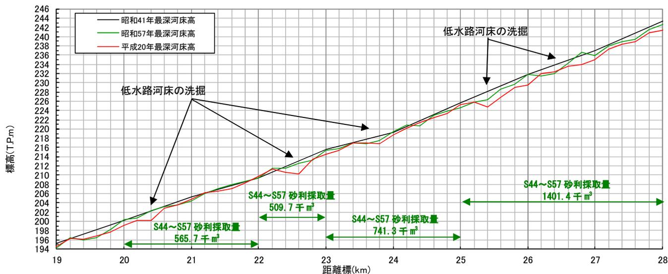
図 3.2(2) 最深河床高の縦断形状の変化
