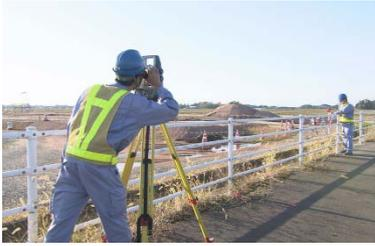
測量の現場では、いろいろな測量機器を使って、土地の距離・角度・高低差などを正確に測って土地の形状を表す「地形図」を作成します。
