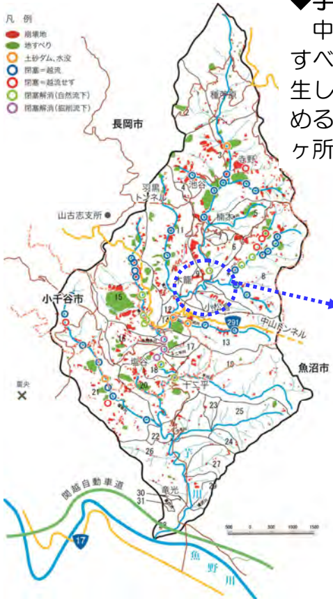
中越地震による芋川流域の土砂災害発生位置図
