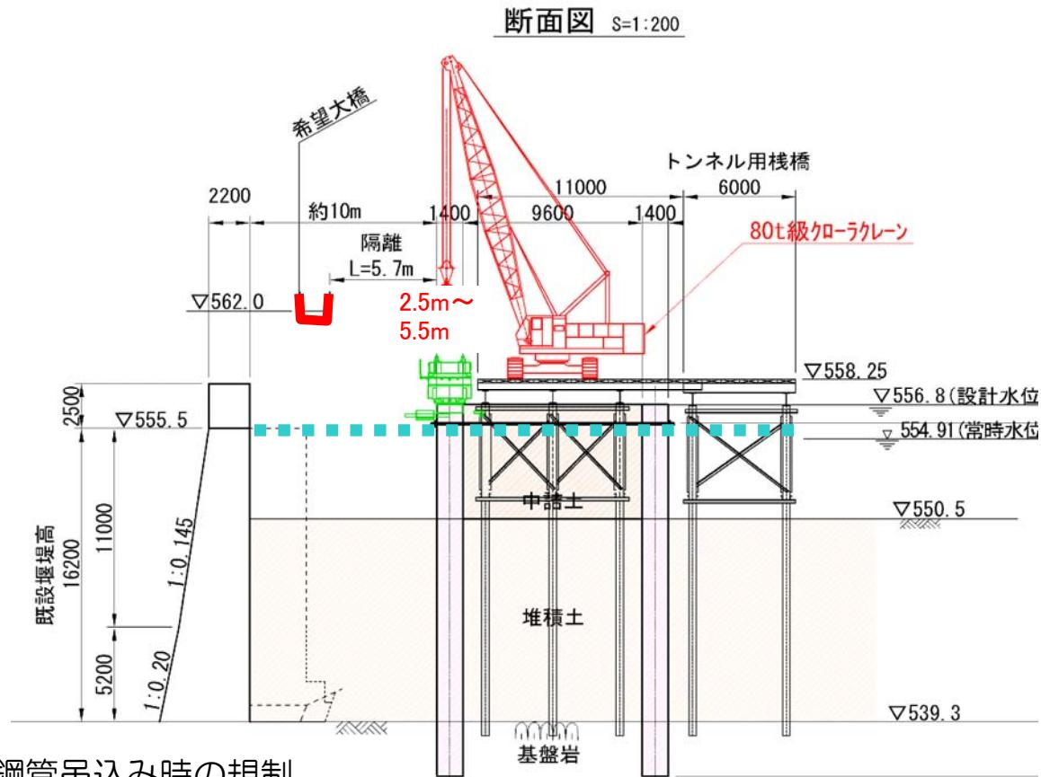
鋼管は仮桟橋上で吊込み、仮締切施工箇所にある機械（ジャイロパイラー）に建込みます。吊り込んでクレーンが旋回する時から、機械に建込み固定するまでの間で吊橋上の通行を規制します（10分程度）。
