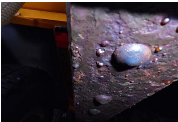
写真-5 無洗浄車両シャシフレーム下部
