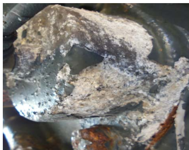
写真-2 ブレーキ部品の減肉状態
