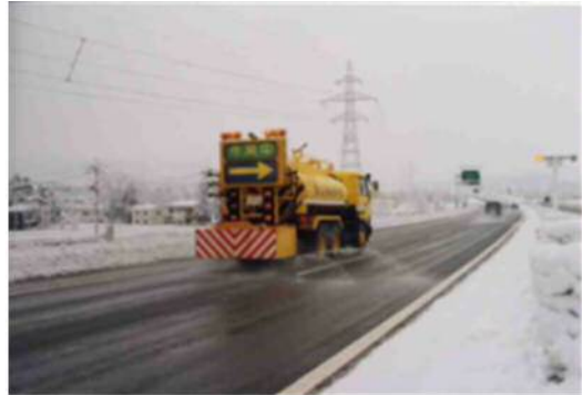
写真1 凍結防止剤散布作業（過去写真）
