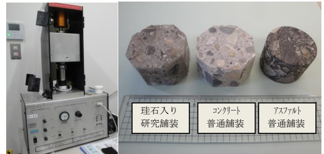
写真-1 舗装の熱伝導率測定機器とサンプル例 （左：測定機器、右：舗装サンプル）
