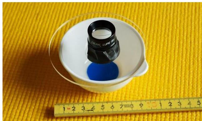
図 5 コンパクトな雪結晶透過光撮影台
