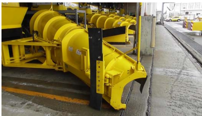
写真-4 ゴム板設置状況
