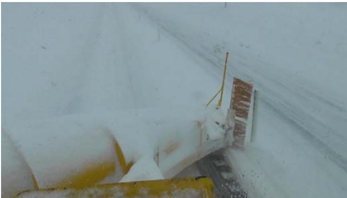
写真-7 ブラシ設置時の作業状況（運転席）
