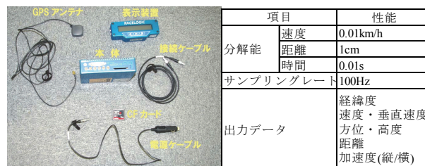
図-3 GPSセンサによる計測装置の概観と仕様
