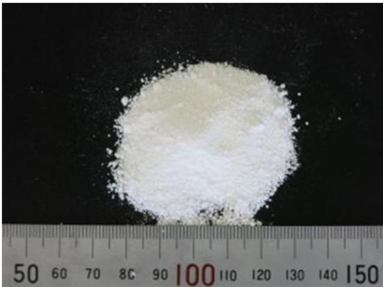
写真-1 プロピオン酸ナトリウム（粉末状）
