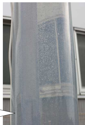
写真6 注水井戸内布袋への 気泡付着と集合での浮上
