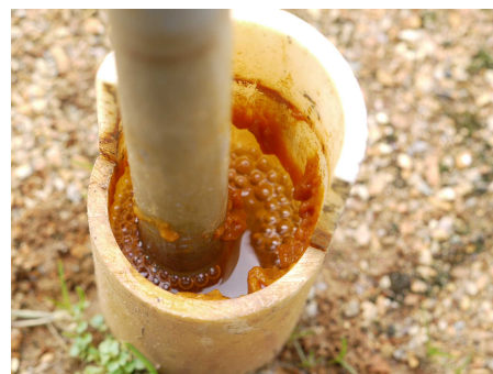
写真2 注水井戸での気泡の浮上
