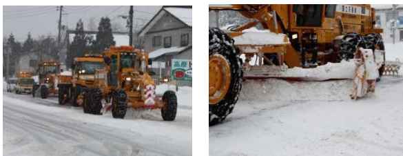
写真6 新型除雪グレーダ梯団除雪作業状況
