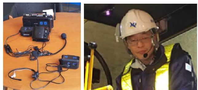
写真5 通信装置（インカム）
