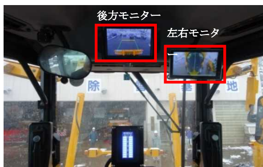
写真2 新型除雪グレーダの安全性確保対策 (モニターカメラ取付状況)
