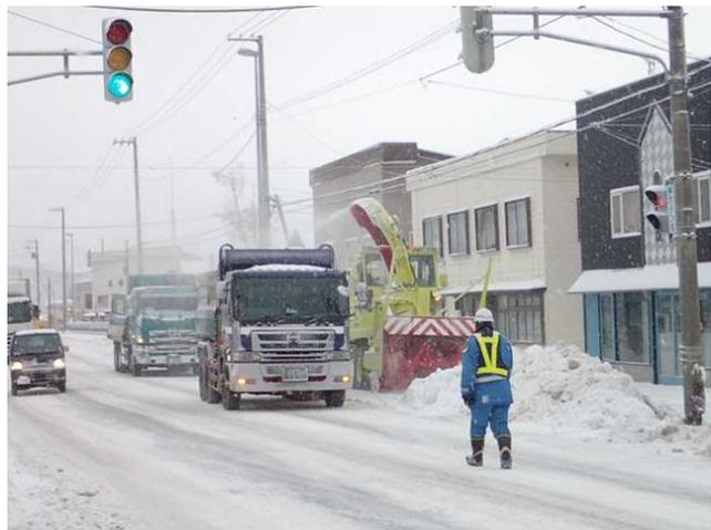
写真－４ ロータリによる運搬排雪作業状況
