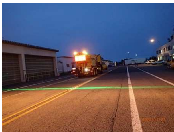
写真3 セーフティラインの照射状況
