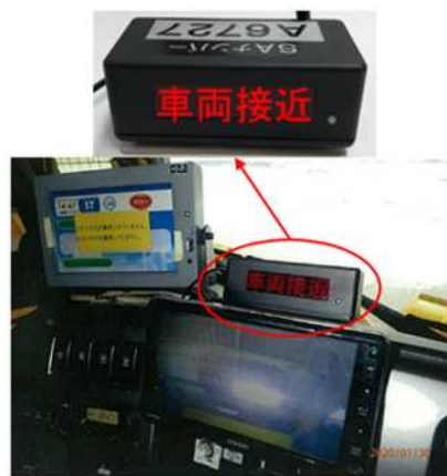
写真8 除雪車車内モニター
