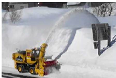
写真1 ロータリ除雪車
