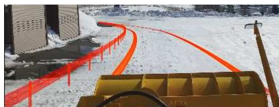
図2 ガードレールや外側線の認識イメージ
