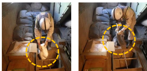
写真-2 合材プラントでの添加材料投入状況 (左：化学系材料投入状況，右：弾性材料投入状況)
