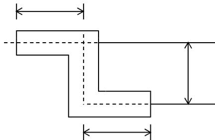
カ 配管配線は原則として図面上の平面部分と立上り、引下げ部分とに区分する。
