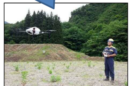
③ドローンによる空中写真撮影
