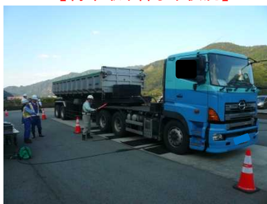
重量測定状況
