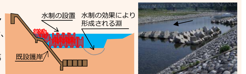
自然再生（生物の生息場となる淵の整備）（富山市八尾町西神通）
