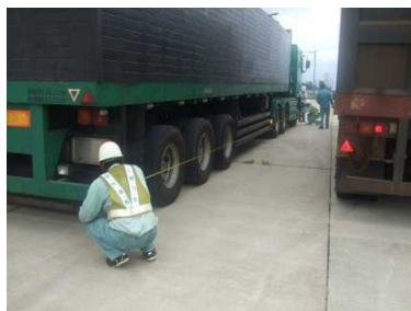
寸法測定状況
