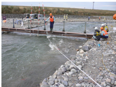
通水時の流量の測定
