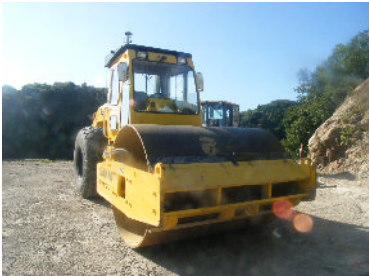
振動ローラー(10t級) (転圧管理システム搭載)
