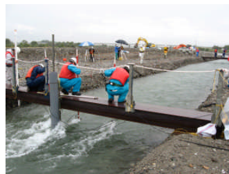
通水時の流量の測定
