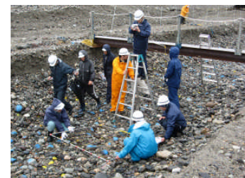
通水後の河床材料の調査
