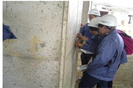
ひび割れ幅を測定している状況
