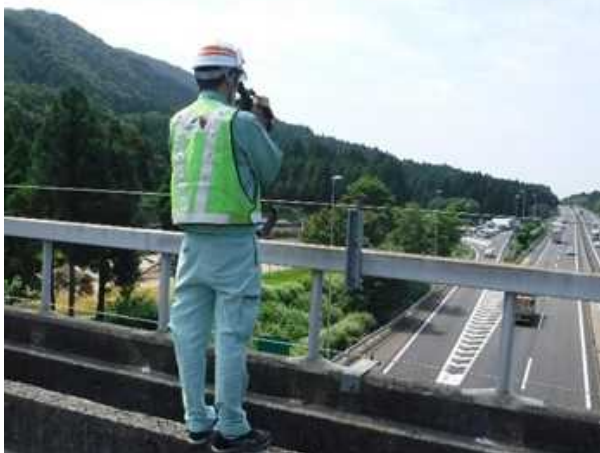
赤外線カメラによる撮影状況
