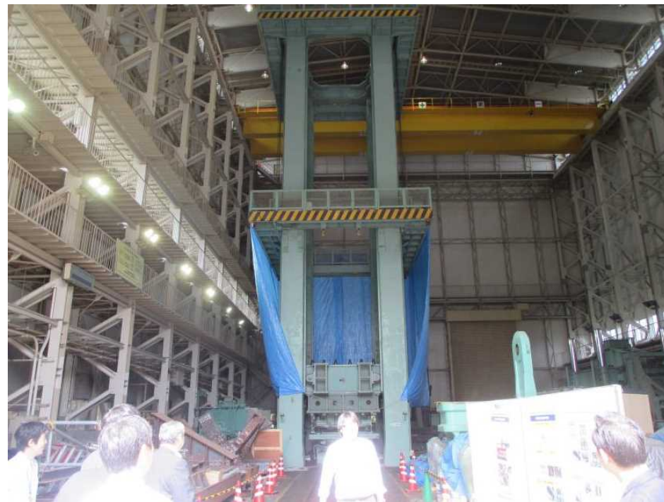
土木研究所の300N（3000T）載荷試験機
