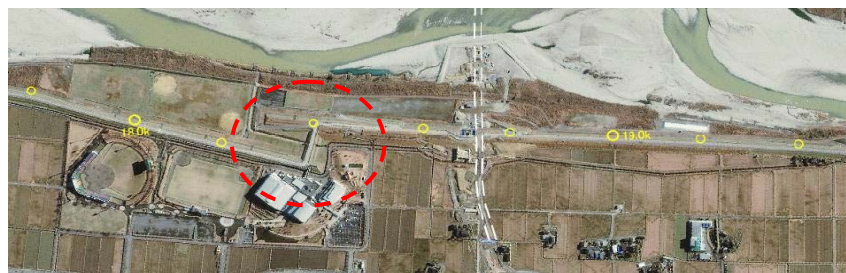
図 3-26 治水機能が失われた霞堤 (左岸 17.8km 付近)
