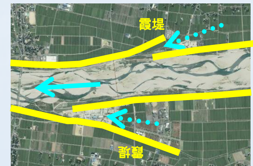
霞堤による洪水被害の軽減 4 (イメージ図)
