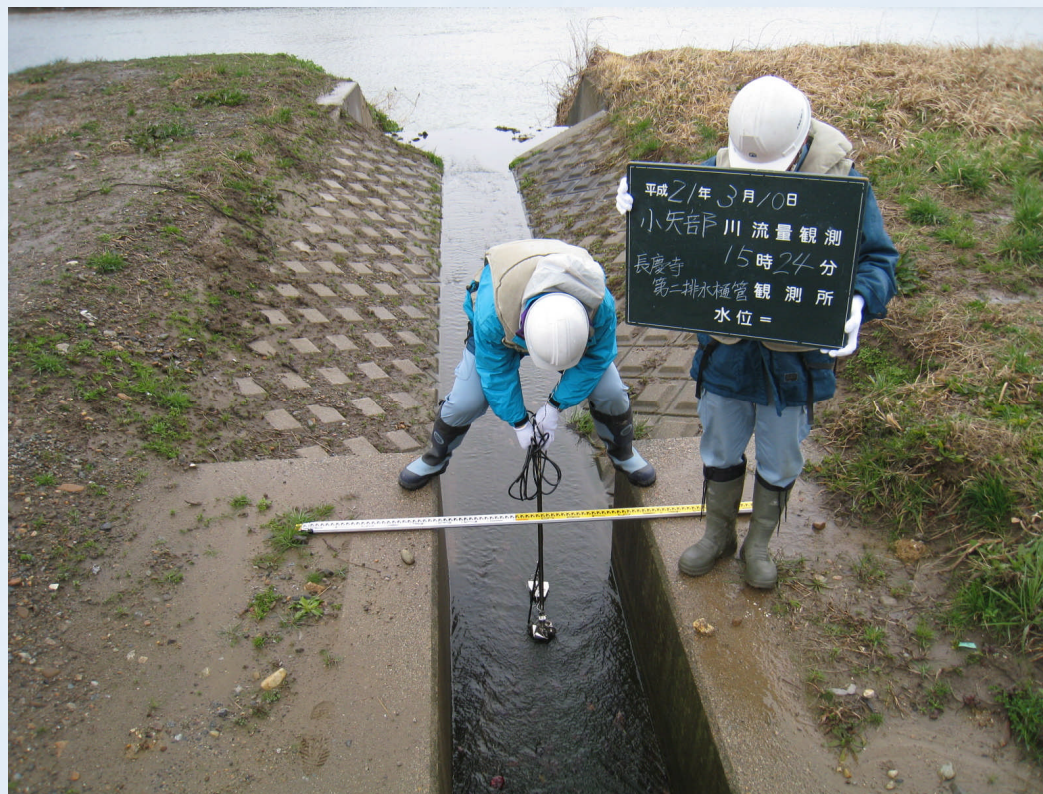
同時流量観測の状況
