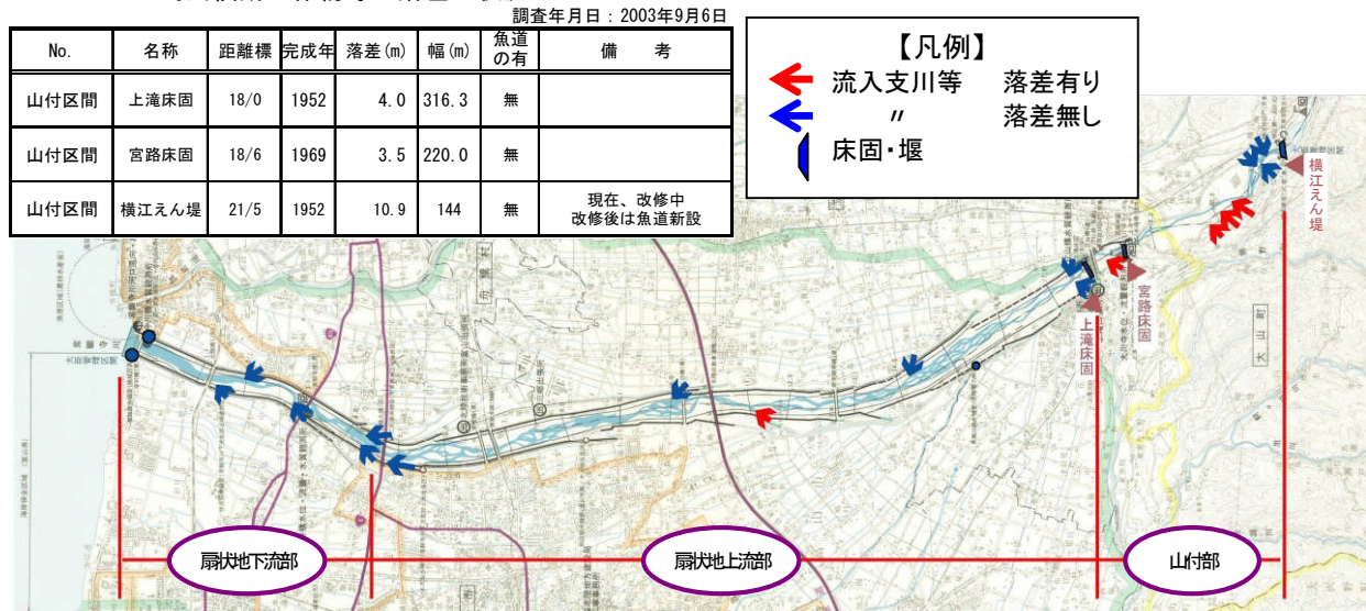
常願寺川に流入する支川・樋門等の落差の状況
