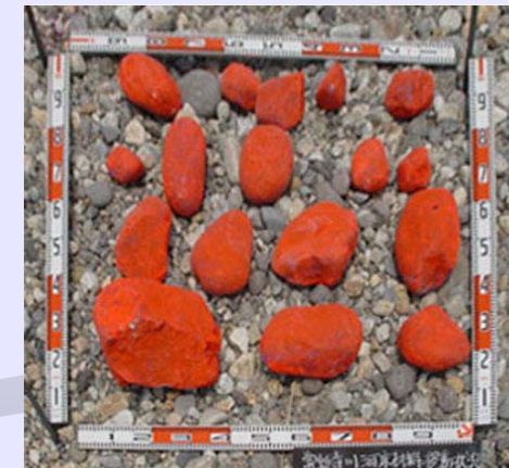
河床材料調査 (トレーサーの設置)
