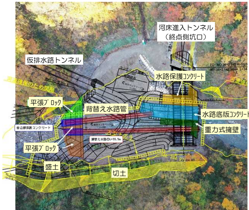
図-1 吐口部造成ヤード整備工計画図【当初】
